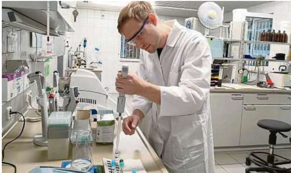
Im Labor der Kläranlage wird das Wasser aus den Becken auf die vorgeschriebenen Grenzwerte untersucht. Redakteur Joshua Bär testet, ob der Nitritgehalt im erlaubten Rahmen liegt.
